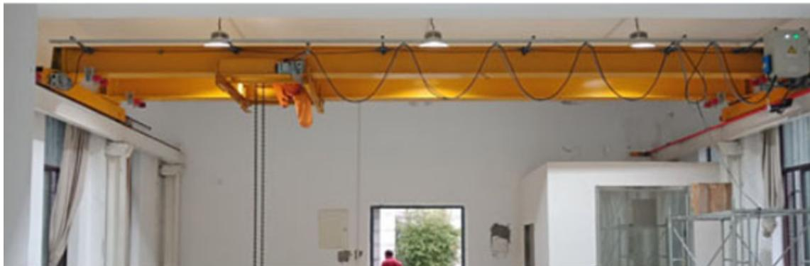
双梁起重机，或双梁桥式起重机，电动双梁起重机；一、产品构成：电动双梁起重机，主要由双主梁、横梁装置、运行小车、电动葫芦、限位装置及控制系统等组成；二、产品特点1. 配置急停开关、短路保护、失压保护、相序保护等功能；2. 起升、小车、大车三机构单独控制，能单独或同时运行；3. 所有连接采用快插式重型航空插头插座，密封好，接插牢固，便于维护；4. 插头连接部位采用塑料套管绝缘保护；5. 小车限位装置，可根据实际使用调整位
