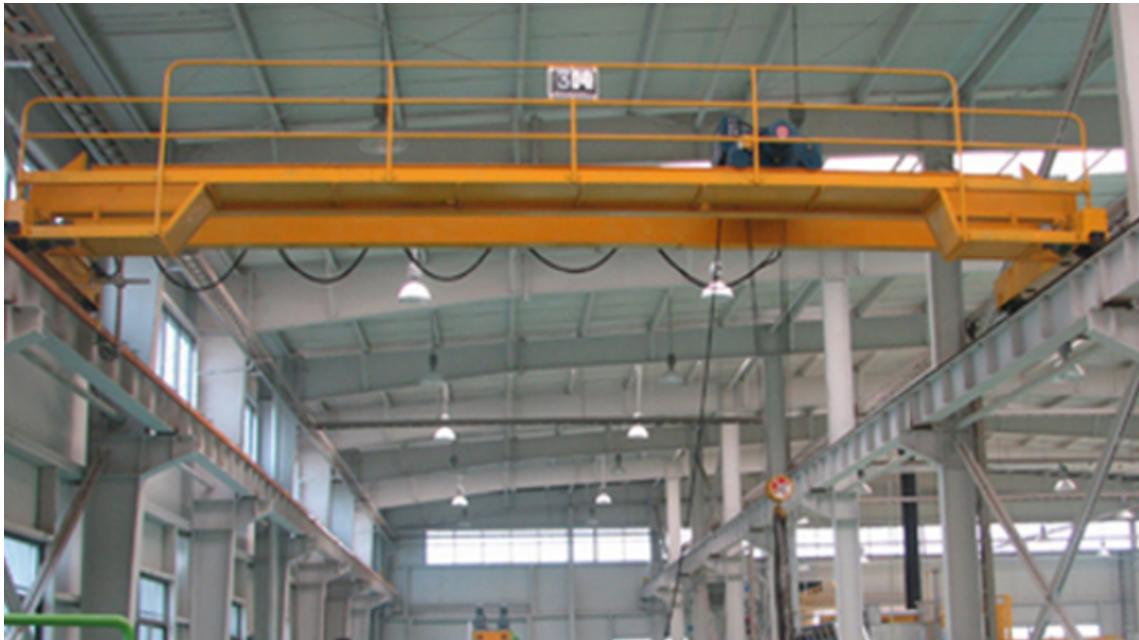
双梁起重机，或双梁桥式起重机，电动双梁起重机；一、产品构成：电动双梁起重机，主要由双主梁、横梁装置、运行小车、电动葫芦、限位装置及控制系统等组成；二、产品特点1. 配置急停开关、短路保护、失压保护、相序保护等功能；2. 起升、小车、大车三机构单独控制，能单独或同时运行；3. 所有连接采用快插式重型航空插头插座，密封好，接插牢固，便于维护；4. 插头连接部位采用塑料套管绝缘保护；5. 小车限位装置，可根据实际使用调整位置；6. 移动供电系统采用起重机的PVC扁电缆，耐压等级达到450/750V 7 小车移动供电系统采用内置式电缆滑车、镀锌轨道和扁电缆等供电；8. 超载限制器；9. 上下限位开关；10. 控制方式，手电门，无线遥控，半自动，全自动控制。三、适用场合1. 多用于起重量小、频繁程度不高的场合。
